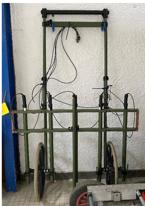
Figure 8 - Chariot modulable MXPDA à cinq sondes avec un écartement de 0,25cm
