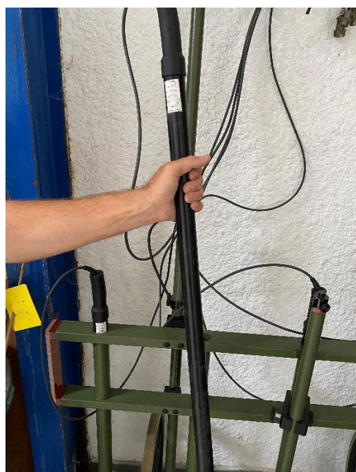
Figure 9 - Sonde fluxgate FGM650/3 de la marque Sensys
