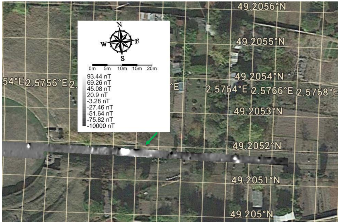
Figure 15 Carte magnétique du couloir des arènes réalisé avec un écartement de 0,5cm et une gamme de variation de [-100 nT,100 nT]. Cette gamme de variation permet d'observer d'importantes anomalies positives le long du Vestibule Est . Par la suite une importante anomalie positive de forme circulaire pourrait induire une structure bien individualisée et délimitée. Une grille est présente (flèche verte) et perturbe les mesures
